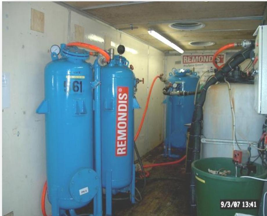
Pilotanlage, bestehend aus Belüftungssystem, Dosierstation, Filter- und Rückspüleinheit sowie Wasser-Aktivkohlestufe
