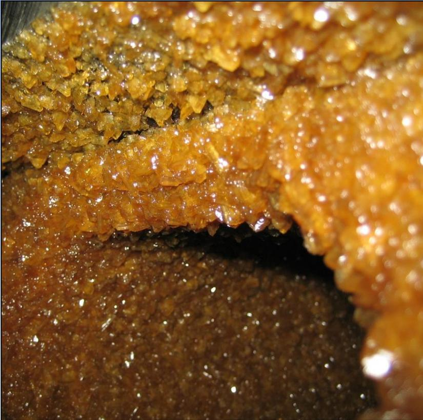
Struvit - Ablagerungen in der Drehkolbenpumpe (Perkolat-DL)
